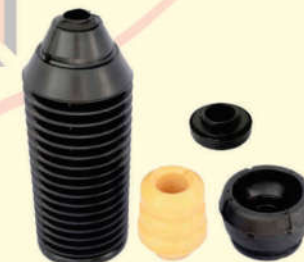
6215 005 - MB4276 Completo Dianteiro Gol G6 12...16/Gol G7/Polo 17... Saveiro/Voyage 12.../Nivus 20... T-Cross 19.../Virtus 18... UP! 14...21/A1 11...18
