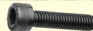
Parafuso Allen com cabeça 10mm AÇO 12.9 Rosca Total Fio 1,5 CH Allen 8mm
