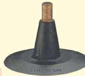
0703 007 002 Válvula p/ câmara comprimento 35mm p/furo 15,7mm TR15 c/base borr./vulcanite automóveis/caminhonetes
