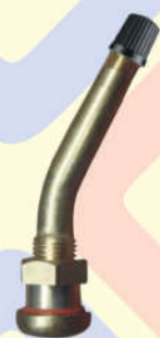
0703 002 003 Válvula pneus s/ câmara 60mm p/ furo 9,7mm 27 graus V3-20-4 raiada
