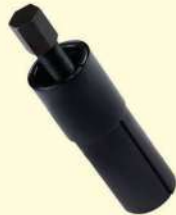
8695 004 047 Saca engrenagem comando virabrequim CG 125/ Today/ Titan 125 (sem desmontar o motor)
