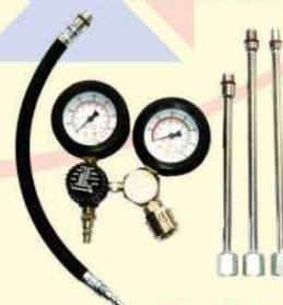
0690 048 Teste vazão de cilindro de motores (p/ motos) Analisa a perda de ar comprimido no cilindro; diagnosticando sede de válvulas, juntas e cabeçotes e folga em pistões/anéis.
