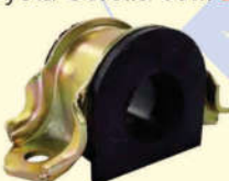
6201 129 Kit barra estab. diant. Hyundai Cerato/i30 09... 23,8mm
