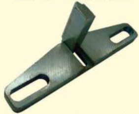
0626 015 (101008) Ferramenta ajustável para travar volante. Aplicada no local de fixação do motor de partida, indicada p/ KA/New Fiesta 1.0 12V 3 Cil. e veículos onde for elevado o torque de aperto do parafuso da polia da arv. de manivelas
