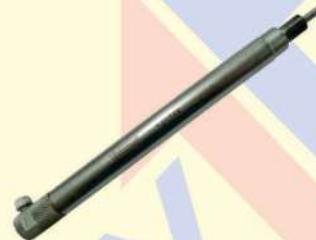
0626 124 (141358) Suporte com rosca de M14 x 1,25, para relógio comparador (10mm de curso) utilizado para a verificação do PMS do 1º cilindro do Palio/Brava/Marea e motores de 16V e 20V com vela central, em geral.
