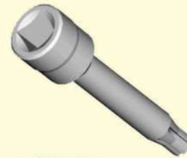
0626 133 (141387) Ferr. especial (perfil RIBE 10) c/ encaixe de 1/2" p/ parafusos do cabeçote motores Fiat Fire 1.0/1.3 16V. Utilizar a chave nº 141362 para soltar o cabeçote superior.
