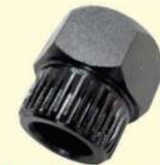
0626 037 (108001) Soquete especial estriado com 33 dentes e sextavado de 25mm, para a polia com catraca da marca INA, de alternadores Valeo e Bosch. Utilizar com chave Torx T50 ou multidentada de 10mm, não fornecidas pela Raven.
