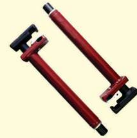
0626 188 (103007) Par de encolhedores de molas suspensões diant. do tipo MacPherson encaixe quadrado 1/2" p/ uso com chave pneumática ou catraca manual de curso de 250mm molas entre 100 e 206 mm c/ espessura max. 17mm *Não atende molas de Blindados/utilitários
