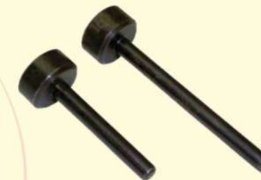
0626 153 (161006) Ferramenta para posicionar os comandos de válvulas durante a troca da correia dentada de motores 2.0 16V. Modelo EW10AF. Citroën Picasso/ C4 Pallas, C4 VRT e Peugeot 307/407 e 807. Uso em conjunto com a ferr. 161004.
