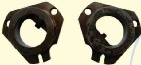
0626 123 (141357) Conj. com 2 ferramentas, para posicionar em PMS os eixos de comando de válvulas do motor Fiat 1.6 16V do Palio/Siena/Strada/Brava durante a troca da correia dentada.
