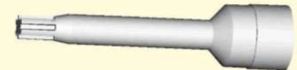
0626 126 (141362) Chave especial (perfil RIBE 9) com encaixe de 1/2", para os parafusos da tampa superior dos comandos de válvula do motor Fiat 1.6 16V e Fire 1.0/1.3 16V.
