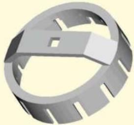
0626 080 (117076) Chave de garras com 136mm e encaixe de 1/2", para a porca plástica do conjunto bóia/bomba de combustível do Gol, Parati, Saveiro, Santana, Logus e Pointer.
