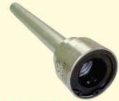
0626 033 (105001) Chave especial auto-ajustável, com encaixe de 1/2", para juntas axiais da caixa de direção (rótulas), com diâmetros entre 36mm e 41mm.
