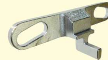
0626 149 (151008) Ferramenta para travar o volante dos motores Renault 1.0, 1.6 8/16V. Esta ferramenta é instalada no lugar do sensor de rotação exceto em motores c/ transm. automática
