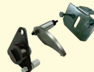
0626 122 (141356) Conjunto de ferramentas para posicionar em PMS o eixo do comando de válvulas e a polia da árvore de manivelas e travar o volante de motores 1.0/1.5 8V do Palio/Sienna Strada durante a troca da correia dentada.
