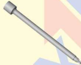
0626 082 (121003) Chave Torx T40, longa 180mm encaixe 3/8" para parafusos do cabeçote (M8 parte dianteira), motor Zetec Rocam 1.0/1.6 8V
