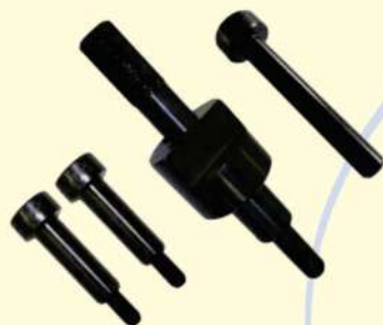
0626 152 (161004) Conjunto de pinos p/ posicionar os pistões a meio curso e os eixos de comando de válvulas, durante a troca da correia dentada. Motores Citroën/Peugeot 2.0 16V, geração EW, posteriores a 2001. Veículos 307/406 02... 807/C5/C8/Picasso e Xsara 02...
