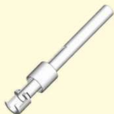
0626 139 (143354) Chave com encaixe de 1/2" para soltar a junta axial da caixa de direção (rótula) do Uno, Tempra, Palio/Logus/Corsa, etc. Entalhe da rótula com 32mm. Sempre utilizar a luva que acompanha a ferramenta.
