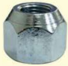
6200 12 006 Porca de roda diant./tras. Frontier LL até 07/Sentra/X-Trail (M12x1,25 ch. 21) vazada
