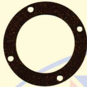
6566 101 Cubo truck Randon(4 furos) Medida interna = 13,5cm Medida externa = 17,5cm Furos = 8mm, Largura = 2cm Espessura = 2mm
