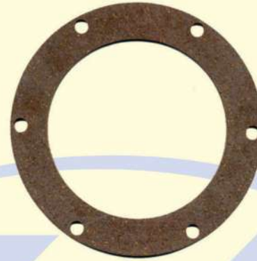
6566 102 Cubo carreta Randon(6 furos) Medida interna = 16,1cm Medida externa = 19,5cm Furos = 7mm, Largura = 1,5cm Espessura = 2mm
