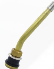
0703 002 004 Válvula pneus s/ câmara 85mm p/ furo 9,7mm 27 graus V3-20-6 raiada
