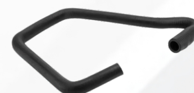
6203 401 Mang. bomba d'água ao cabeçote Gol/Parati AE/CHT 1.0 95... (261210532/J-MM 3190)
