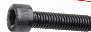
Parafuso Allen com cabeça 10mm AÇO 12.9 Rosca Total Fio 1,5 CH Allen 8mm
