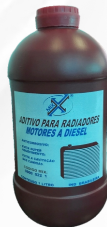
0900 022 1 - Vermelho Anticorrosivo p/ Radiadores com motor a diesel (Uso 1 parte aditivo p/ 24 de água) p/ caminhões antigos que não sejam injeção eletrônica (Ex. MBB cabine redonda) 1 litro
