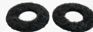
0903 087 Protetor p/ polos de bateria. É um anel que libera componentes protetores nos polos e terminais da bateria. Esses componentes possuem ação anticorrosiva que impedem a formação de zinabre.
